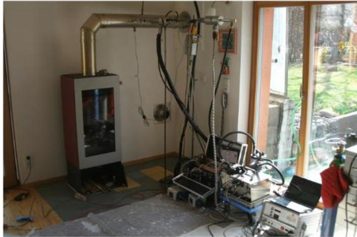
Abbildung 37: Aufbau der Messtrecke beim ausgewählten Privatbetreiber für die Feldmessung
