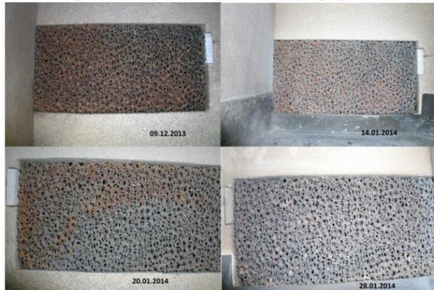
Abbildung 39: Fotografien des Wandkatalysators (MnO<sub>x</sub>/Al<sub>2</sub>O<sub>3</sub>-Schwamm) nach Einsatz im Kaminofen am Feldstandort über 75 Tage
