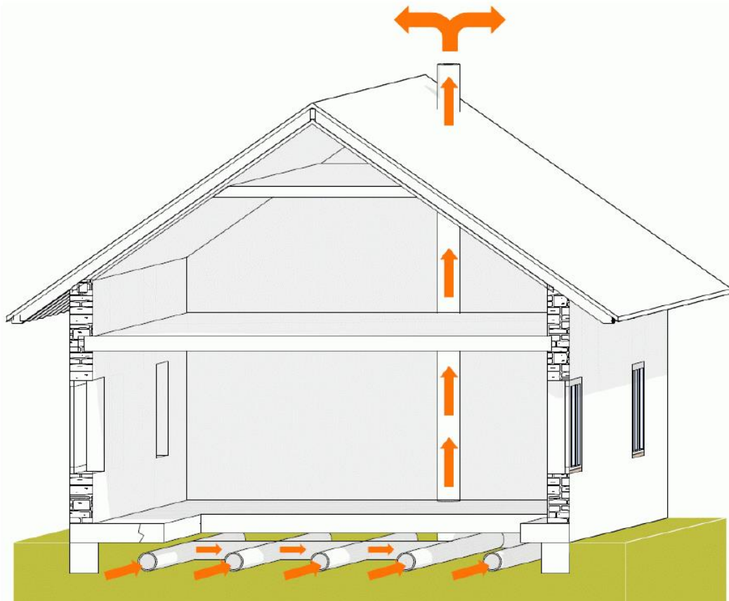
Abb. Prinzipskizze einer Radondrainage
